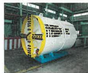
写真 シールドマシンの例
