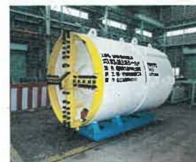
写真 シールドマシンの例
